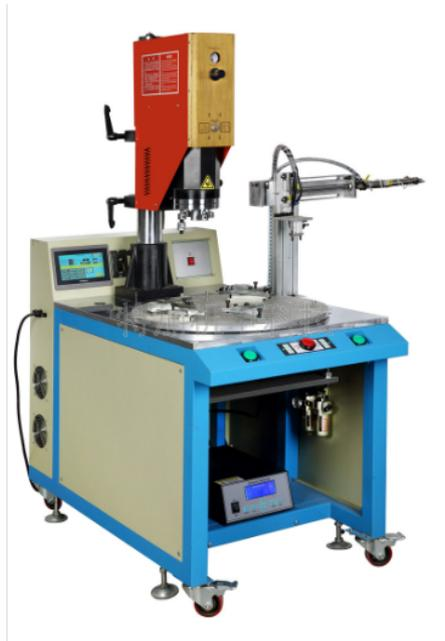
校模：为达到高的生产效率，焊头与塑料件之间的距离应尽量缩短但仍需留有足够的空间方便取放塑料件。1将塑料件放在底座中调整气压在2Kg左右，利用焊头升降开关来使上下摸对准确。2选择适合的焊头与塑料件之间的距离锁紧机架固定把手。3调整限位螺栓使焊头下降压紧塑料件之后仍有0.2mm左右的空间。（对于焊接深度要求较高的塑料件，此空间相应加大）。4调整焊接、保压时间、气压、试焊样件。5观察样件，如发现焊接不均匀，则需要细调底座的平衡，一般原则为焊接部位熔接越厉害，则应调低，在底座相反位置垫上纸片等抬高底座对应位置，使塑料件与焊头吻合良好。影响塑料件超声加工的因素如下：（1）接触面的设计（2）焊接线的设计（3）塑料材质（4）塑料件外形和尺寸（5）焊接面与焊头之间距离（6）焊头的设计（7）焊头的振幅（8）校模的准确性（9）焊接压力、时间参数的选择
