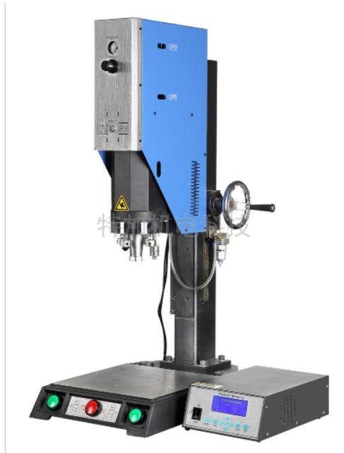
振幅对于需要焊接的材料来说是一个关键参数, 相当于铬铁的温度。温度达不到就会熔接不上, 温度过高就会使原材料烧焦或导致结构破坏而强度变差。选择的超声波换能器不同, 换能器输出的振幅都不同, 经过适配不同变比的超声波变幅杆及焊头, 能够校正焊头的工作振幅以符合要求。通常换能器的输出振幅为10—20 $\mu\text{m}$ □而工作振幅一般为30 $\mu\text{m}$ 左右, 变幅杆及焊头的变比同变幅杆及焊头的形状, 前后面积比等因素有关。形状来说如指数型变幅、函数型变幅、阶梯型变幅等, 对变比影响很大, 前后面积比与总变比成正比。选用的是不同品牌的焊接机, 简单的方法是按已工作的焊头的比例尺寸制作, 能保证振幅参数的稳定。天津手持式焊接机单价温州市特加机电科技有限公司致力于提供塑料焊接机设备, 欢迎您的来电哦!
